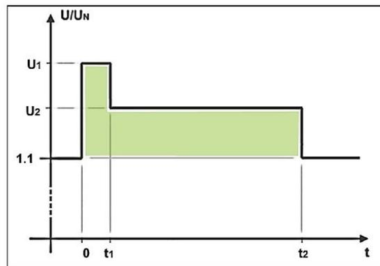
Figura 8. Curva tensão-tempo exigida no que respeita à sobrevivência a sobretensões às instalações do tipos C e D
