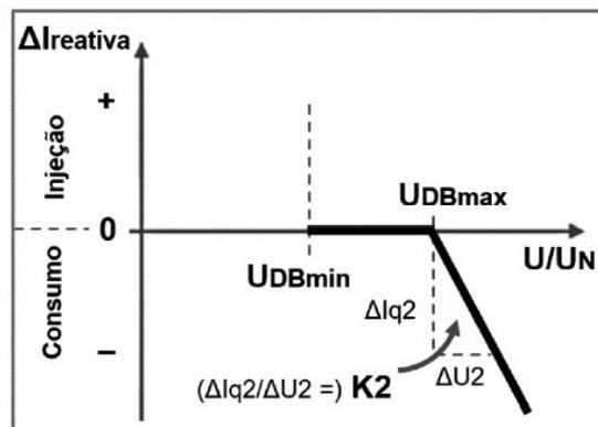
Figura 9. Característica corrente reativa-tensão exigida durante sobretensões às instalações dos tipos C e D
