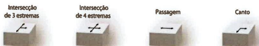
FIGURA 37 - COLOCAÇÃO DE SETAS DE DIREÇÃO
