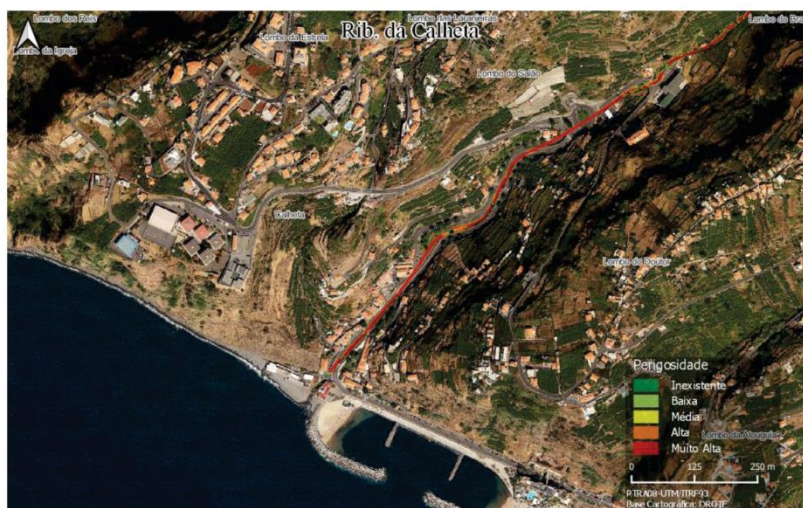
Figura 68 - Perigosidade de inundação: ARPSI da Rib. da Calheta
