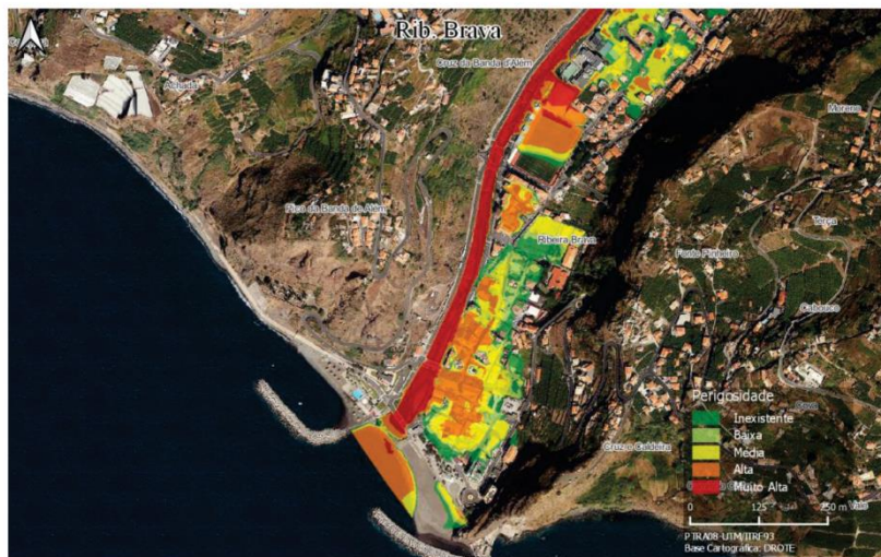
Figura 50 - Perigosidade de inundação: ARPSI da Rib. Brava
