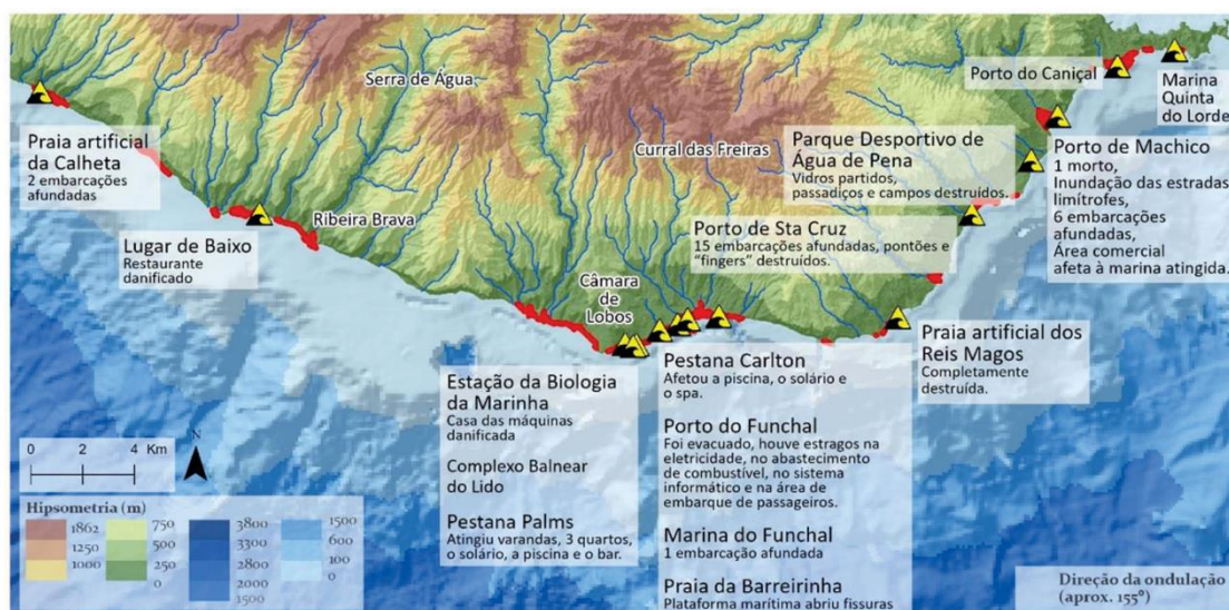
Figura 9 - Danos provocados pelos galgamentos costeiros nos dias 10 e 11 de dezembro de 2013.
