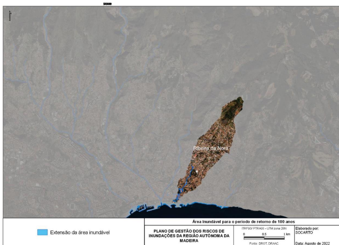
Figura 23 - Extensão da área inundada para o período de retorno de 100 anos: ARPSI do Rib. da Nora.
