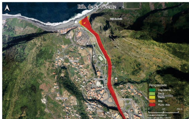
Figura 64 - Perigosidade de inundação: ARPSI do Rib. de S. Vicente
