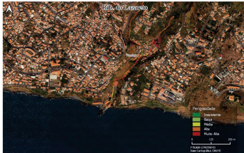
Figura 55 - Perigosidade de inundação: ARPSI da Rib. do Lazareto
